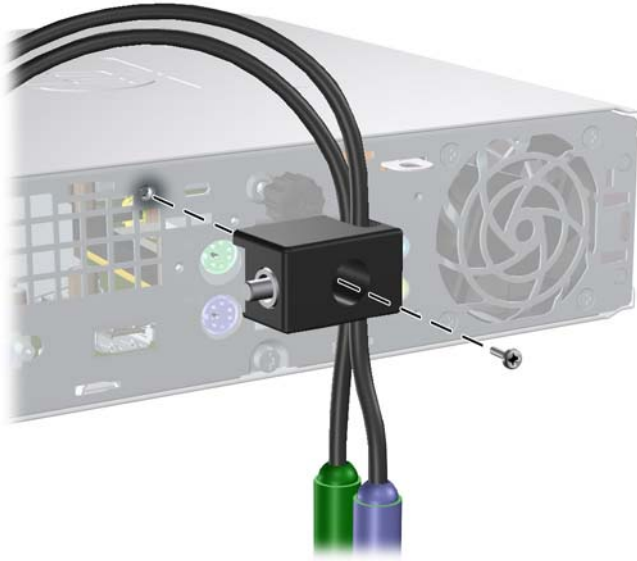
Фигура С-6 Закрепване на ключалката към шасито
