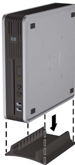
Фигура 2-9 Поставяне на компютъра на стойката
