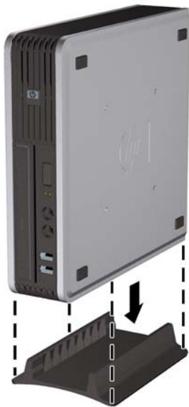
Obrázek 2-9 Vložení počítače do podstavce
