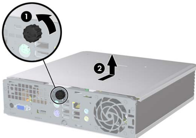
Obrázek 2-2 Odstranění přístupového krytu počítače
