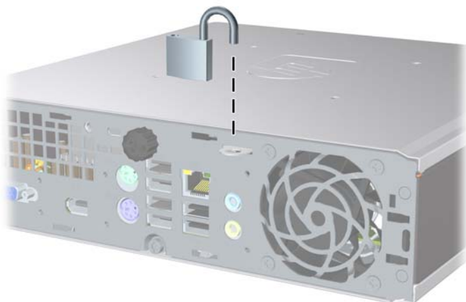
Obrázek C-3 Instalace visacího zámku
