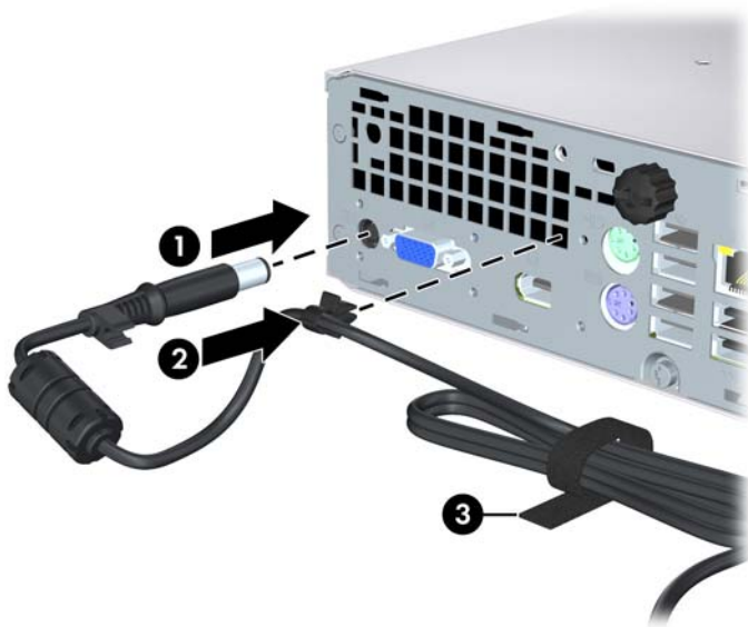
Obrázek 2-1 Připojení napájecího kabelu
