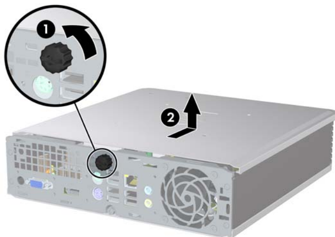
Joonis 2-2 Arvuti külgpaneeli eemaldamine
