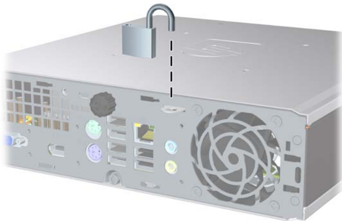
Joonis C-3 Tabaluku paigaldamine
