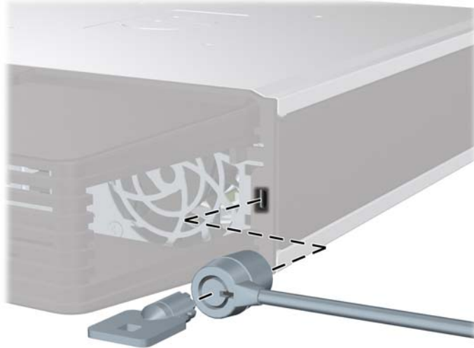
Kuva C-2 Vaijerilukon asentaminen, kun porttikansi on asennettu
