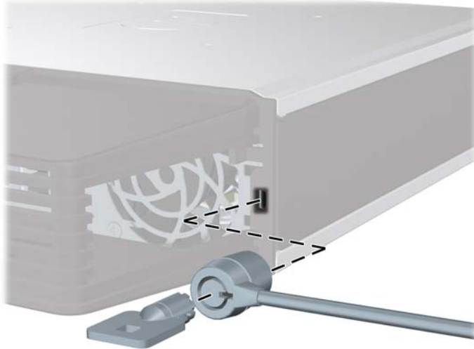
Εικόνα Γ-2 Τοποθέτηση καλωδίου με τοποθετημένο κάλυμμα θύρας
