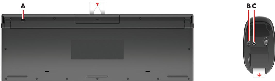
Si el resultado no fuese satisfactorio, desenchufe el receptor del teclado y el ratón inalámbricos de la parte posterior del equipo y vuelva a enchufarlo. Luego, repita el proceso de sincronización.
