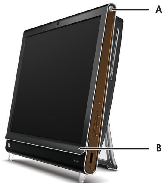
También puede activar el equipo o ponerlo en modo Suspender presionando el botón Encender/Suspender del teclado o del control remoto. Sólo algunos modelos incluyen control remoto.
