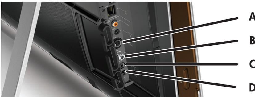
Es posible que necesite un adaptador de video compuesto a S-Video (se vende por separado) desde la salida de video del decodificador al conector de entrada de video **(A)**.
