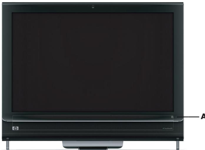
Para abrir el software HP TouchSmart, presione el botón HP TouchSmart **(A)** en la parte inferior del lado derecho del equipo HP TouchSmart.
