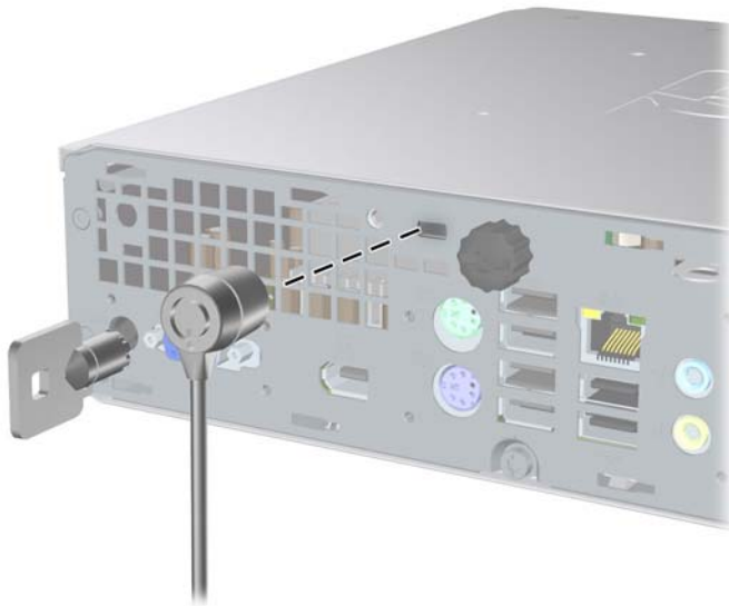
Gambar C-1 Memasang Kunci Kabel Tanpa Penutup Port
