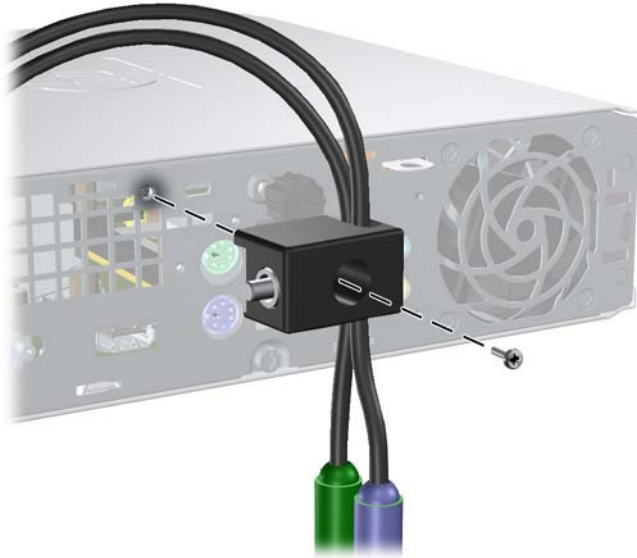
Gambar C-6 Memasang Kunci pada Rangka Komputer
