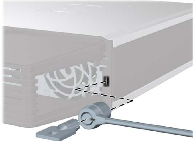
Gambar C-2 Memasang Kunci Kabel dengan Penutup Port Terpasang
