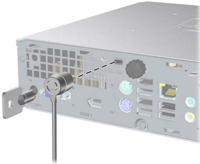
**Figura C-2** Installazione di un cavo con coperchio della porta installato
