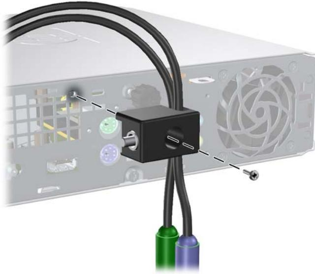
4. Inserte el extremo del cable de seguridad en el bloqueo (1) y presione el botón (2) para activar el bloqueo. Utilice la llave suministrada para desactivar el bloqueo.
