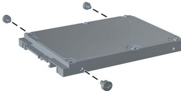
13. Alinee los tornillos guía con las ranuras del transportador y deslice la nueva unidad de disco duro en el transportador (1), luego reinstale el tornillo guía en la parte frontal izquierda del transportador para asegurar la unidad en el transportador (2).
