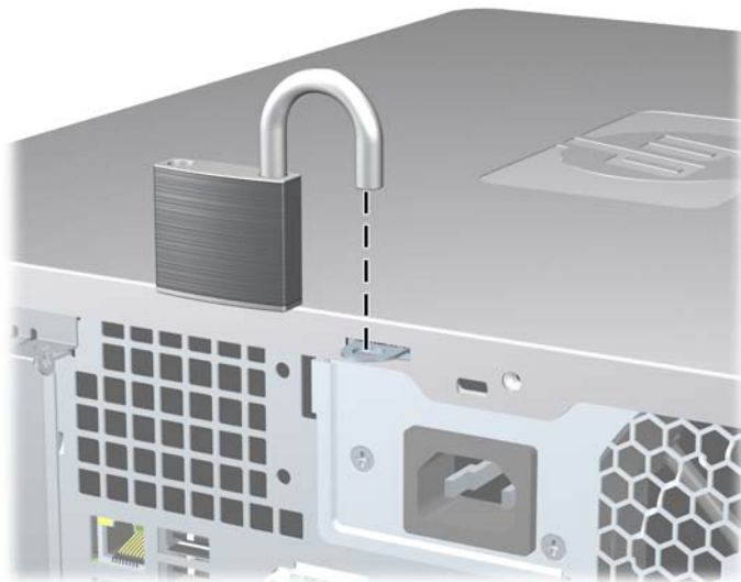
Attēls C-2 Slēdzenes uzstādīšana
