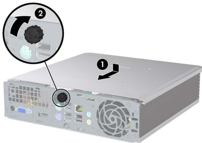
Figur 2-3 Sette tilgangspanelet på plass igjen
