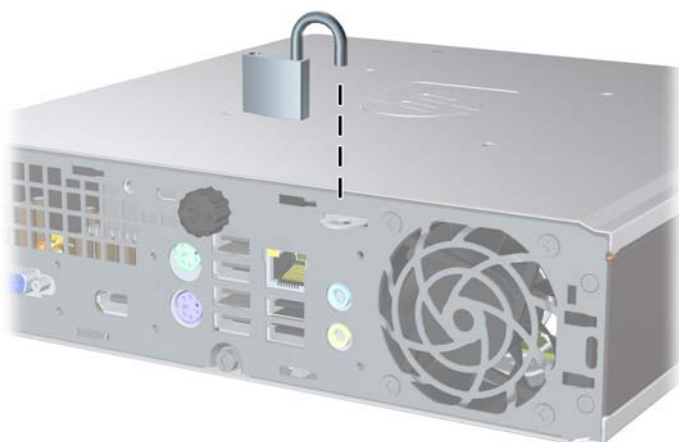
Rysunek C-3 Instalowanie kłódki
