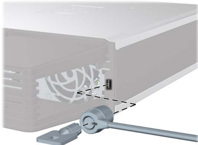
Rysunek C-2 Instalowanie blokady kablowej przy zamontowanej pokrywie portów
