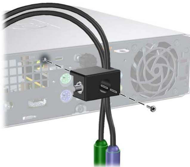
Rysunek C-6 Przymocowanie blokady do podstawy
