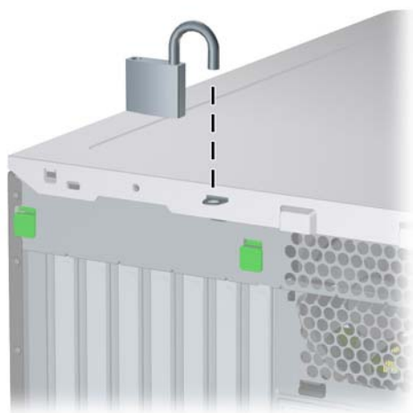
Rysunek C-2 Instalowanie kłódki
