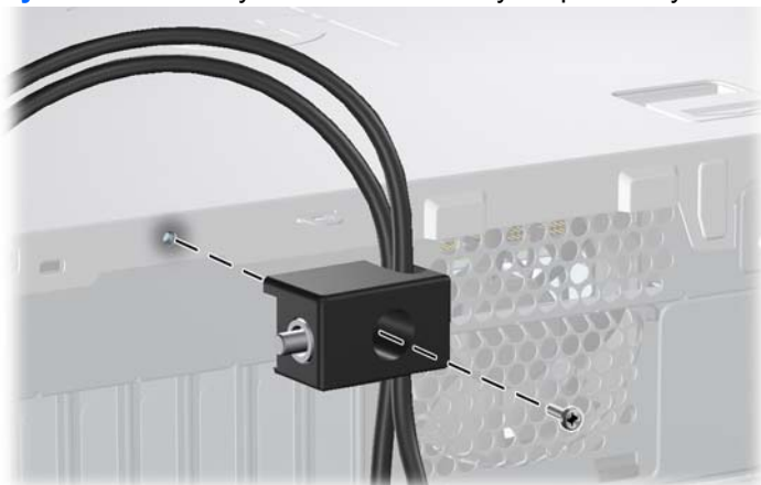
Rysunek C-5 Przymocowanie blokady do podstawy
