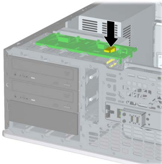
Rysunek 2-42 Zwalnianie napędów 5,25-calowych z wnęk (konfiguracja desktop)
