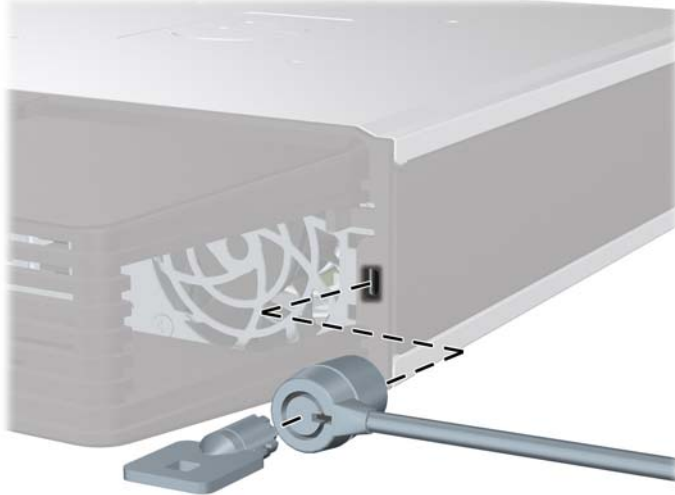
Figura C-2 Instalar um cadeado de cabo com uma tampa de portas instalada
