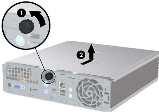
Figura 2-2 Scoaterea panoului de acces în computer
