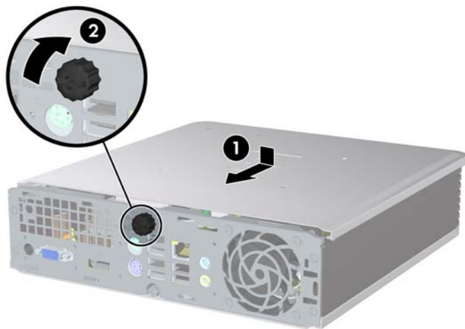
Figura 2-3 Montarea panoului de acces în computer
