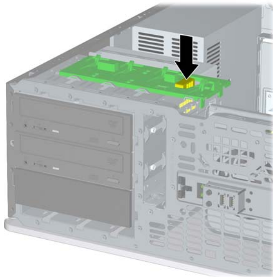
Obrázok 2-42 Uvoľnenie 5,25-palcových jednotiek z pozícií pre jednotky (Desktop)
