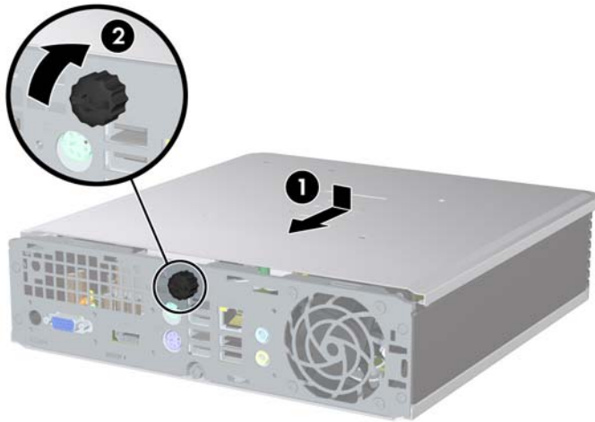
Slika 2-3 Vnovična namestitev pokrova računalnika
