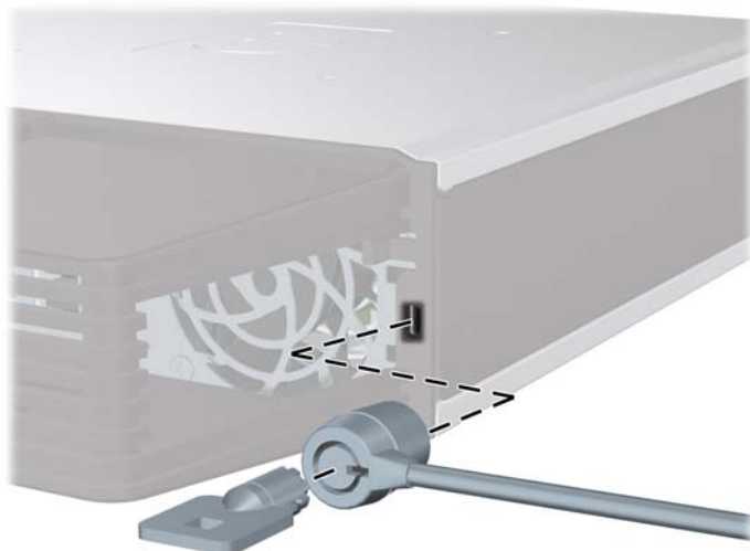
Slika C-2 Namestitev kabljske ključavnice z nameščenim pokrovom vrat
