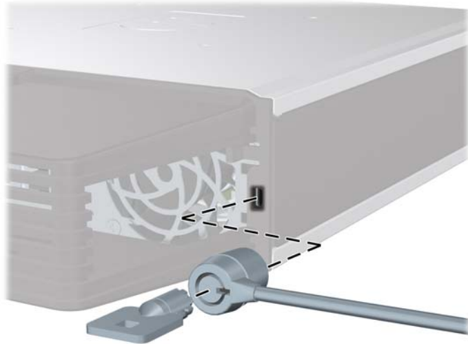
Slika C-2 Ugrađivanje kabela sa ugrađenim poklopcem porta
