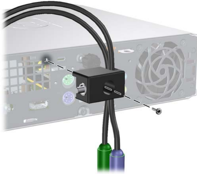
ภาพ C-6 การใส่ล๊อคกับเครื่องโครงเครื่อง
