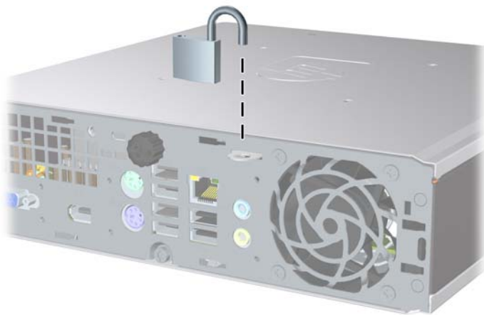
ภาพ C-3 การติดตั้งกุญแจล็อก
