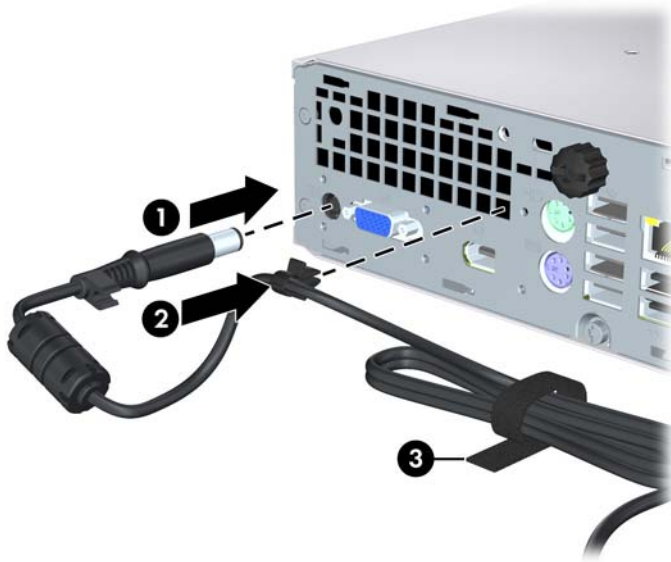
ภาพ 2-1 การต่อสายไฟ
