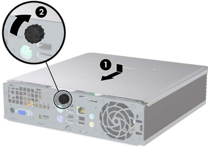
ภาพ 2-3 การใส่แผงปิดเครื่องคอมพิวเตอร์กลับเข้าที่
