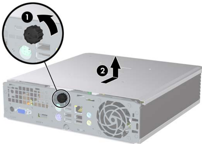
ภาพ 2-2 การถอดแฉงปิดเครื่องคอมพิวเตอร์
