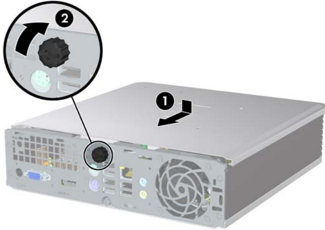
圖示 2-3 裝回電腦存取面板
