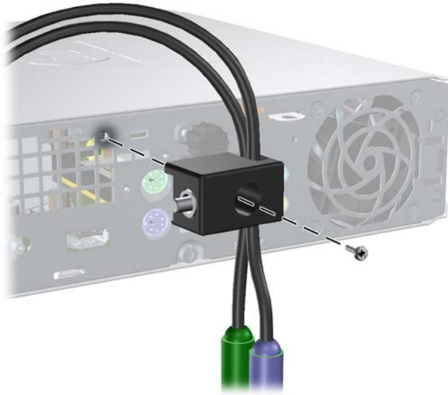
圖示 C-6 將鎖安裝到機箱
