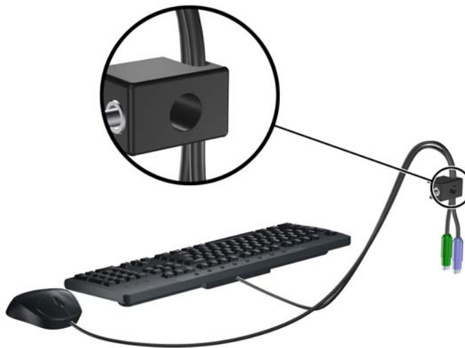
圖示 C-5 穿過鍵盤及滑鼠纜線
