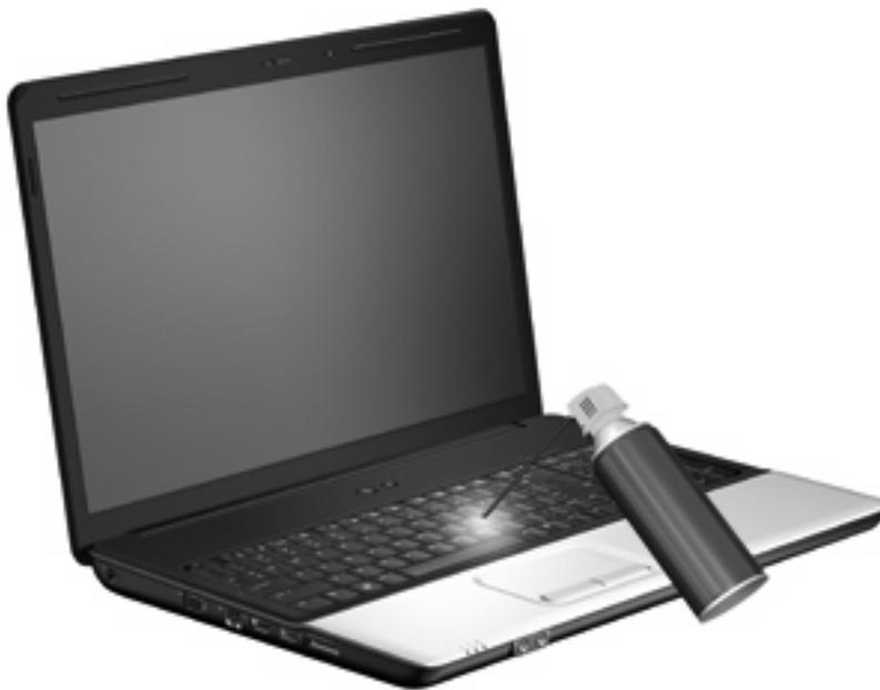
コンピュータのキーボードにポインティングスティックが付いている場合は、ポインティングスティックのキャップを定期的に清掃するか、交換する必要があります（ポインティングスティックのキャップは一部のモデルに付属しています）。
