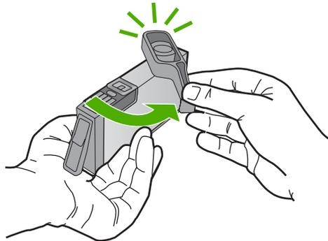
6. Schuif met behulp van de gekleurde pictogramvormen de printcartridge in de lege sleuf tot deze op zijn plaats vastklikt en stevig in de sleuf zit.
