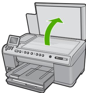
2. Legen Sie das Original mit der bedruckten Seite nach unten so auf das Vorlagenglas, dass es vorne rechts anliegt.
