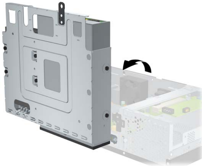
Obrázek B-3 Otočení modulu jednotek nahoru
