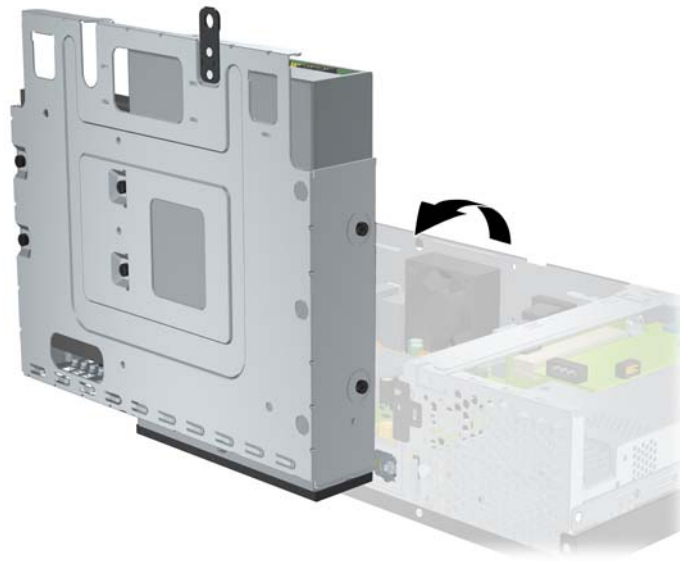
Obrázek D-1 Otočení modulu jednotek nahoru
