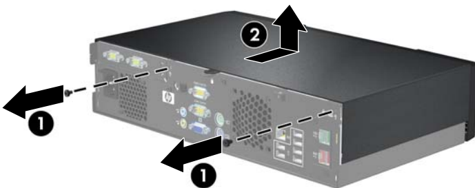
Obrázek 2-1 Odstranění krytu počítače
