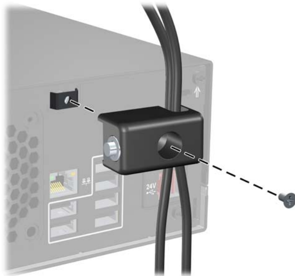
Obrázek E-5 Přichycení zámků k rámu
