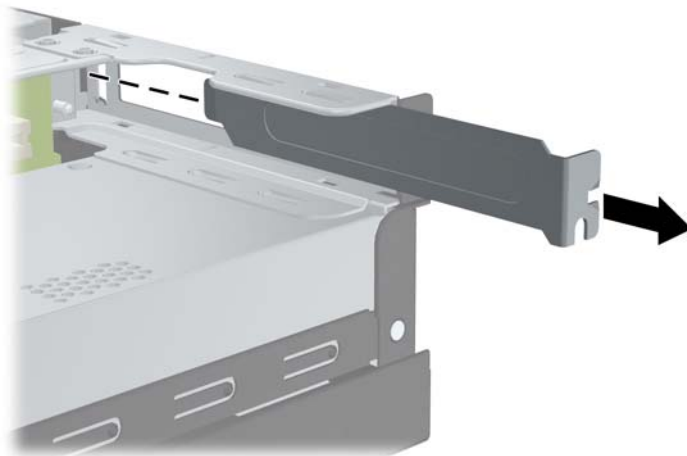
Obrázek 2-10 Odstranění krytu slotu pro rozšiřovací kartu
