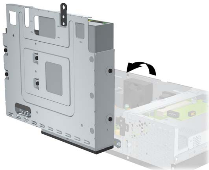
Obrázek C-5 Otočení modulu jednotek nahoru
