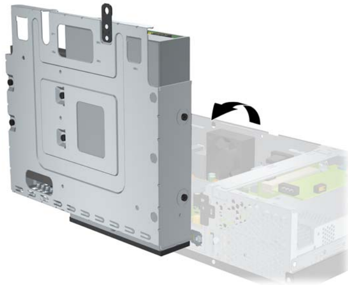
Obrázek 2-22 Otočení modulu jednotek nahoru
