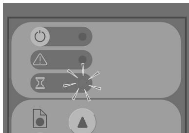
等待灯闪烁表示扫描仪需要重新调整，但无法执行此操作。要解决此问题，请移除扫描仪上的任何纸张，确保将插入槽设置为最低高度，然后等候该等待灯熄灭。
