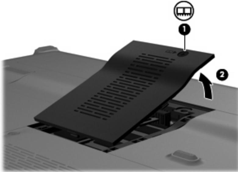
9. Se estiver substituindo um módulo de memória, remova o módulo de memória existente:
