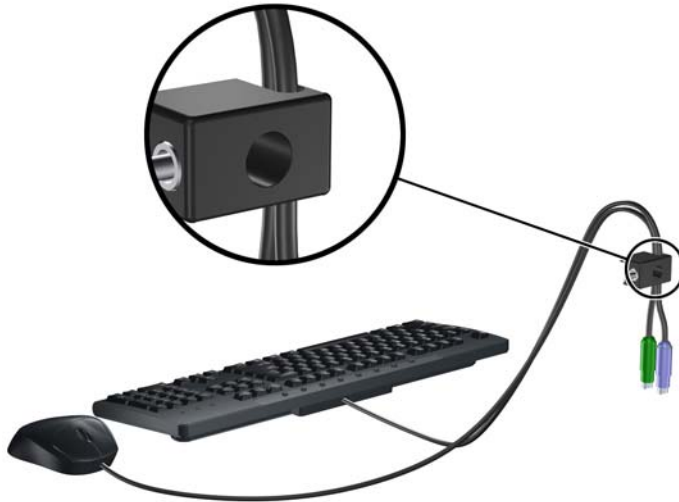
Kuva E-4 Oheislaitteiden kaapelien pujottaminen
