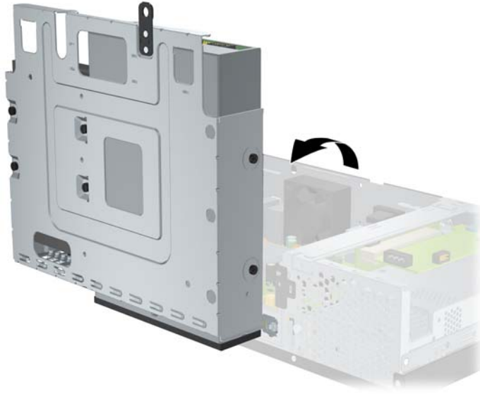
Kuva 2-22 Aseman kehikon kääntäminen pystyyn
