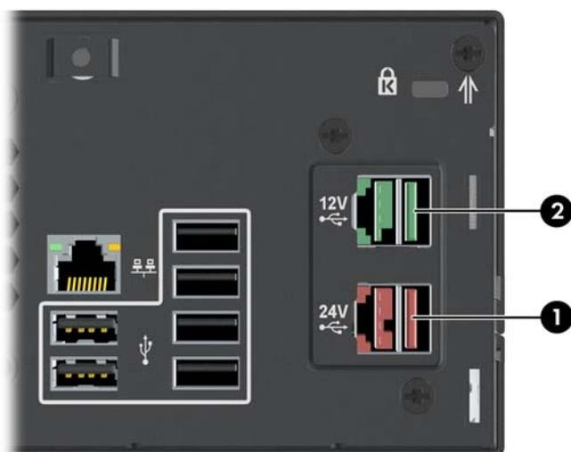
Le connecteur PoweredUSB de 24 volts (1) et le connecteur PoweredUSB de 12 volts (2) sont codés différemment pour éviter toute erreur de connexion.
