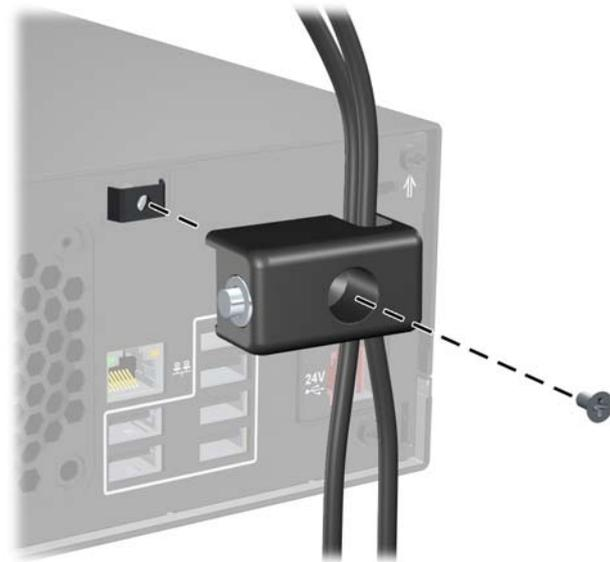
4. Insérez la prise du câble de sécurité dans le verrou (1) et enfoncez le bouton (2) pour fermer le verrou. Utilisez la clé fournie pour ouvrir le verrou.
