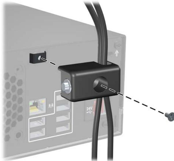
4. Führen Sie den Stecker des Sicherheitskabels in das Schloss ein (1), und drücken Sie den Knopf hinein (2), um das Schloss zu aktivieren. Verwenden Sie den beiliegenden Schlüssel, um das Schloss zu öffnen.
