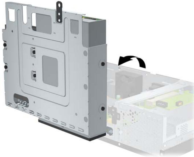
7. Ziehen Sie das Datenkabel (1) und das Stromkabel (2) auf der Rückseite des primären Festplattenlaufwerks ab.
