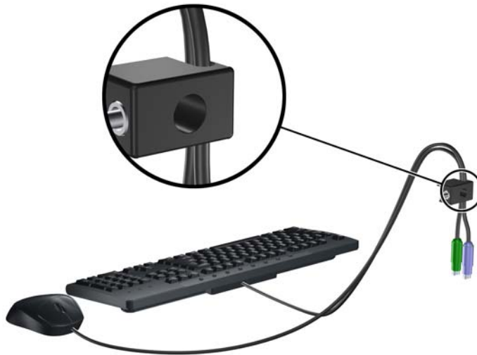
Gambar E-4 Memasukkan Kabel Perangkat Periferap
