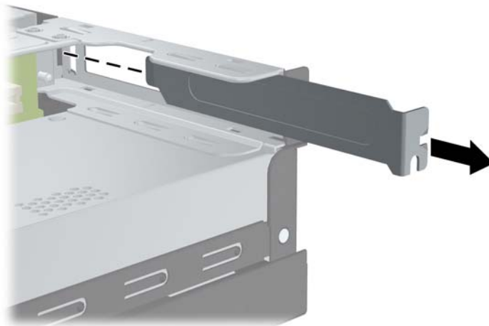
Figura 2-10 Extracción de la Cubierta de Ranura de la Tarjeta de Expansión
