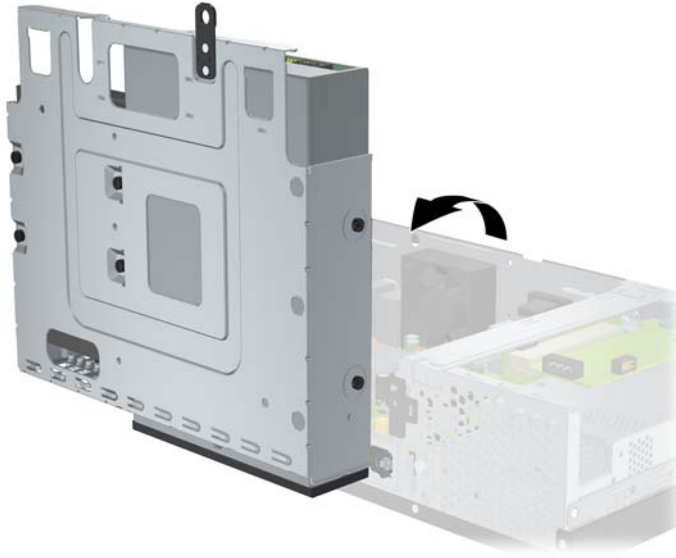
Figura D-1 Giro del compartimiento de la unidad a la posición vertical
