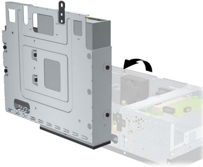
Figura 2-22 Giro del compartimiento de la unidad a la posición vertical
