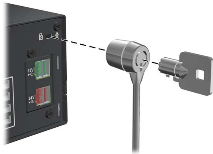
Figura E-1 Instalación de un bloqueo de cable
