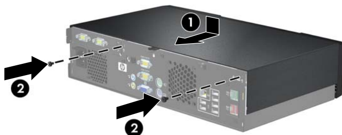
Figura 2-2 Reemplazo de la cubierta de la computadora
