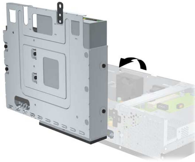
Figura 2-5 Giro del compartimiento de la unidad a la posición vertical
