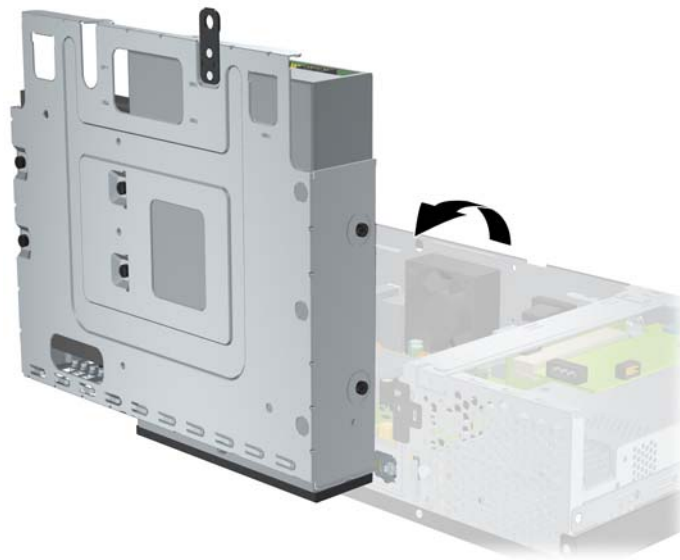
Figura 2-16 Giro del Compartimiento de la Unidad a la Posición Vertical
