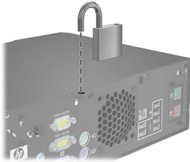
Figura E-2 Instalación de un candado
