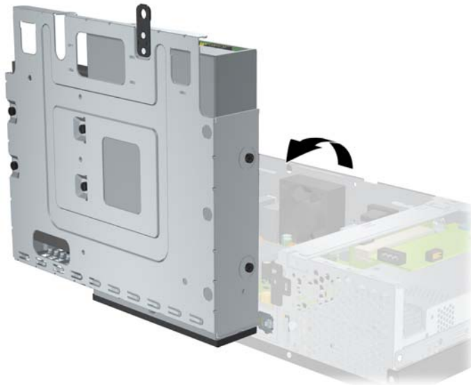
Figura B-3 Giro del compartimiento de la unidad a la posición vertical
