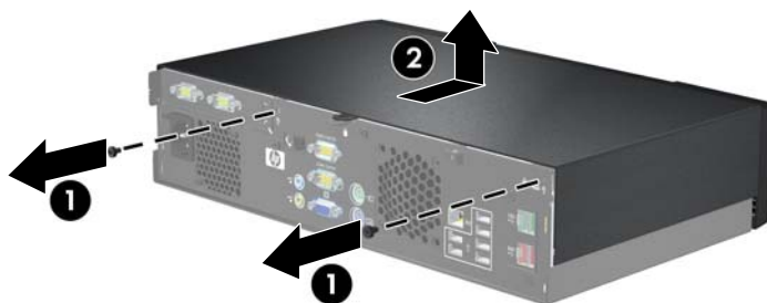
Figura 2-1 Extracción de la cubierta de la computadora
