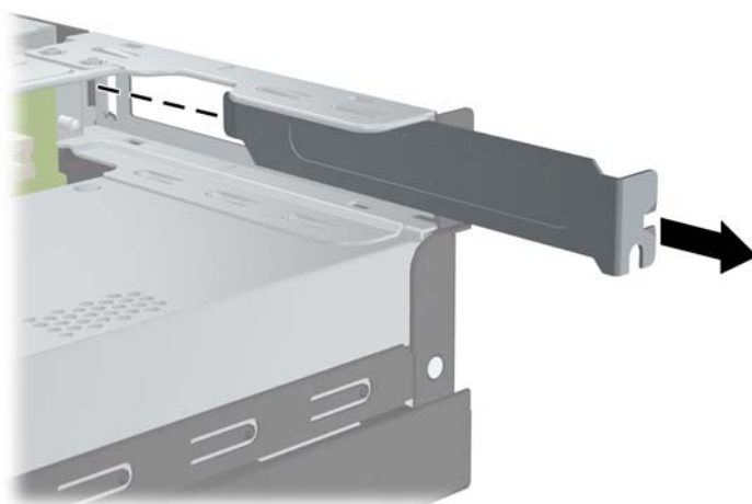
Rysunek 2-10 Usuwanie pokrywy gniazda kart rozszerzeń
