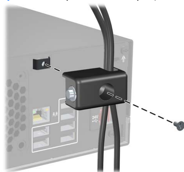
Rysunek E-5 Przymocowanie blokady do podstawy
