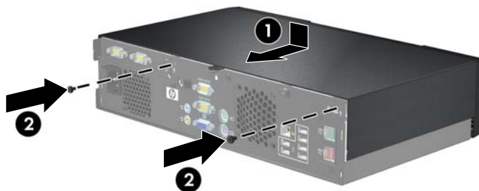
Rysunek 2-2 Zakładanie obudowy komputera
