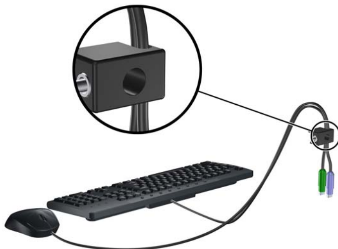
Rysunek E-4 Przewlekanie przewodów urządzeń peryferyjnych
