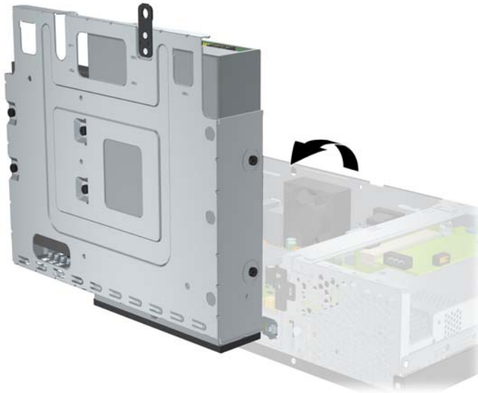
Bild B-3 Vrida upp hårddiskhållaren
