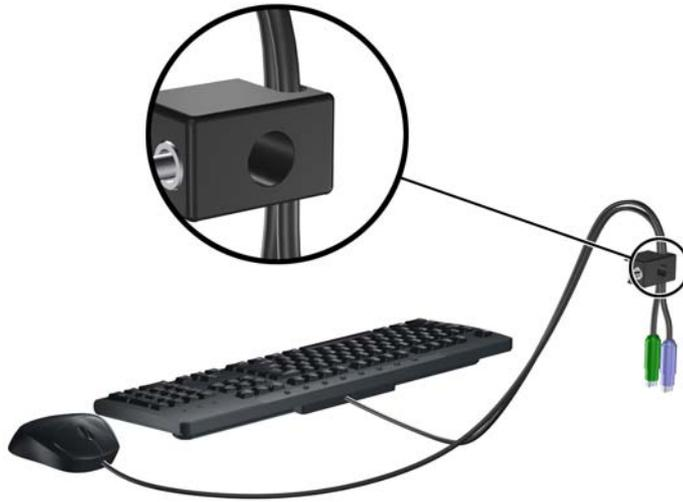
3. 使用鉗夾鎖提供的螺絲，將鎖固定在機箱上。
