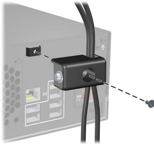
4. 將安全纜線尾端的插銷插入鎖中 (1)，並按下按鈕以嚙合鎖 (2)。使用鉗夾鎖提供的鑰匙，來解開鉗夾鎖。
