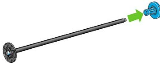
3. 如果捲筒紙中心有三英吋的厚紙板紙筒，請確定已安裝印表機隨附的厚紙板紙筒接頭。
