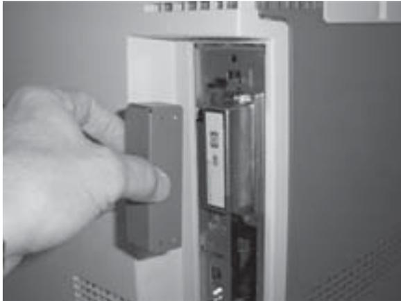
2. Installez le verrou optionnel de type Kensington acheté à cet effet. (Le verrou n'est **pas** fourni avec l'adaptateur de verrou EIO.)
