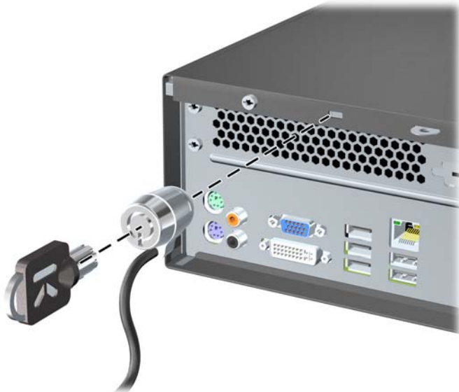
Figura C-1 Instalação da trava de cabo
