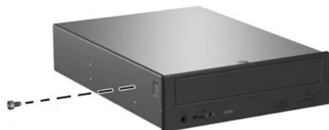
Figura 2-23 Instalação do Parafusos Guia na Unidade Óptica
