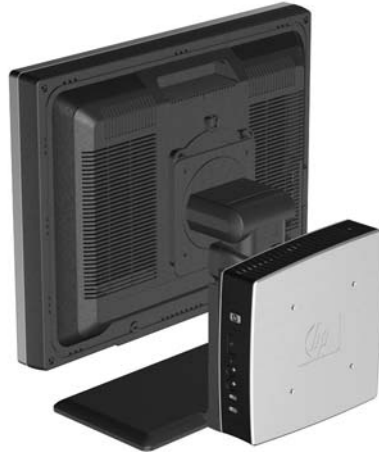
Abbildung C-6 An der Rückseite eines Monitorstandfußes montierter Thin Client
