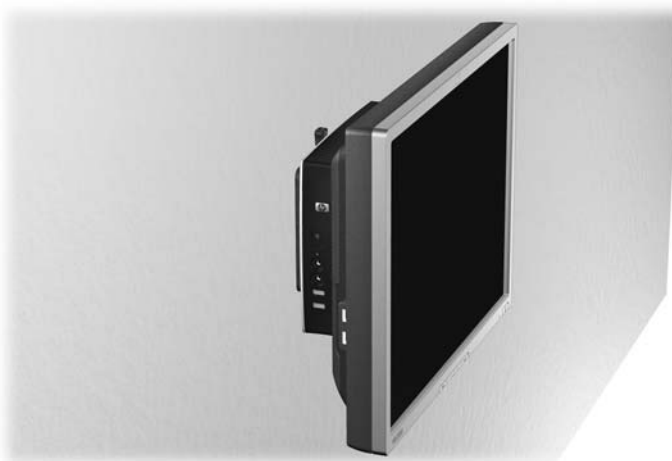
Abbildung C-5 Thin Client, der mit einem Flachbildschirm an der Wand montiert ist
