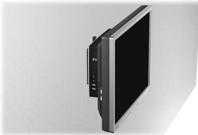
Figura C-5 Thin client montato con pannello piatto a parete
