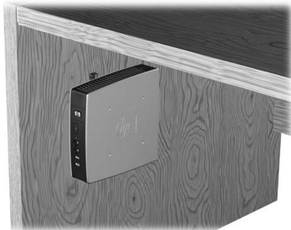
Figura C-8 Thin client montato sotto una scrivania
