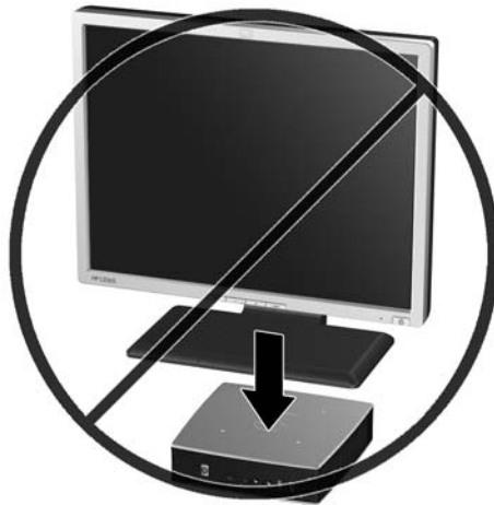
Figura D-5 Non collocare un monitor sul thin client
