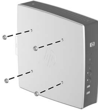
Figura 1-5 Instalación de las patas de goma
