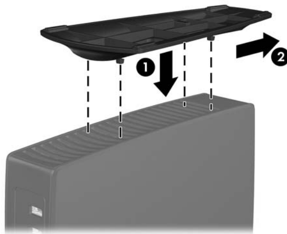
Figura 1-6 Instalación del soporte
