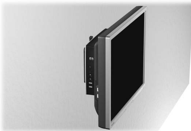
Figura C-5 Thin Client montado con pantalla plana en la pared
