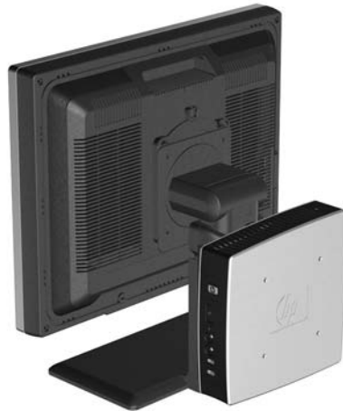
Figura C-6 Thin Client montado en la parte trasera de la base del monitor
