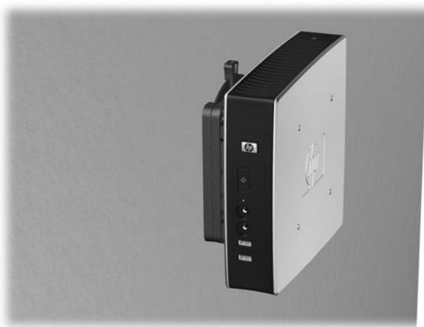
Figura C-7 Thin Client montado en la pared
