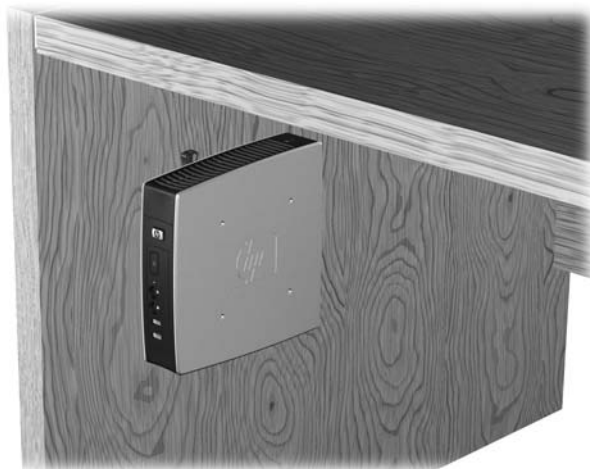
Figura C-8 Thin Client montado debajo de una mesa de escritorio
