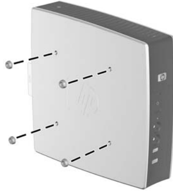
Afbeelding 1-5 De rubberen voetjes installeren
