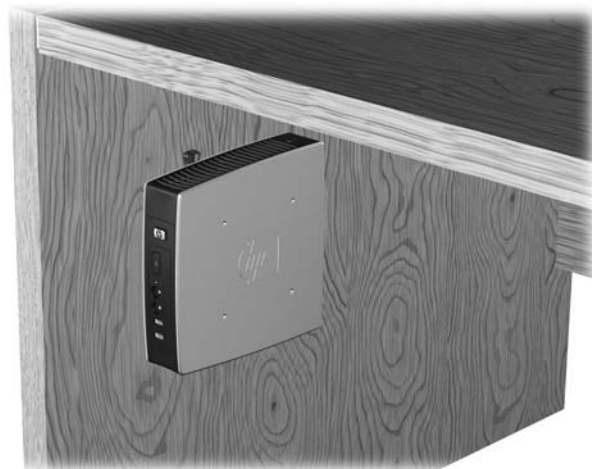
Afbeelding C-8 Thin client gemonteerd onder bureau
