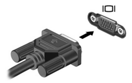
NOTA: Si un dispositivo de visualización externo adecuadamente conectado no muestra ninguna imagen, presione fn+f4 para transferir la imagen al dispositivo. Al presionar fn+f4 varias veces se alterna la imagen de la pantalla entre la pantalla del equipo y el dispositivo.
