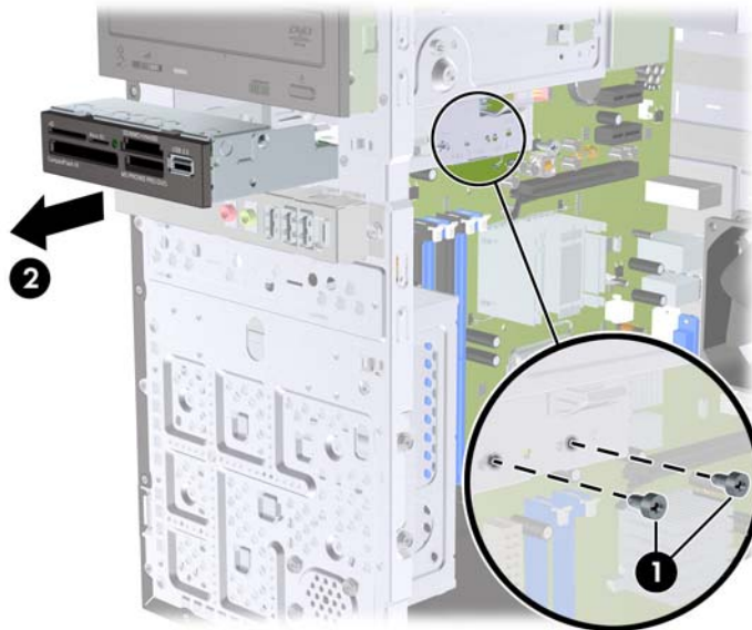
2-24 ábra 3,5 hüvelykes eszköz eltávolítása (az ábrán memóriakártya-olvasó látható)
