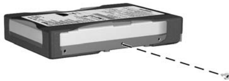
그림 2-38 하드 드라이브에 유도 나사 설치
