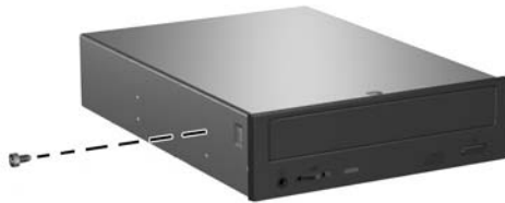
그림 2-23 광 드라이브에 유도 나사 설치
