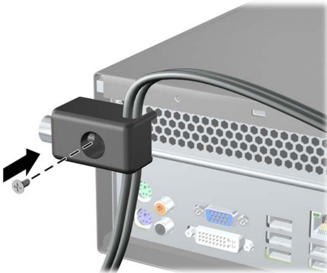
그림 C-5 쉐시에 잠금 장치 부착
