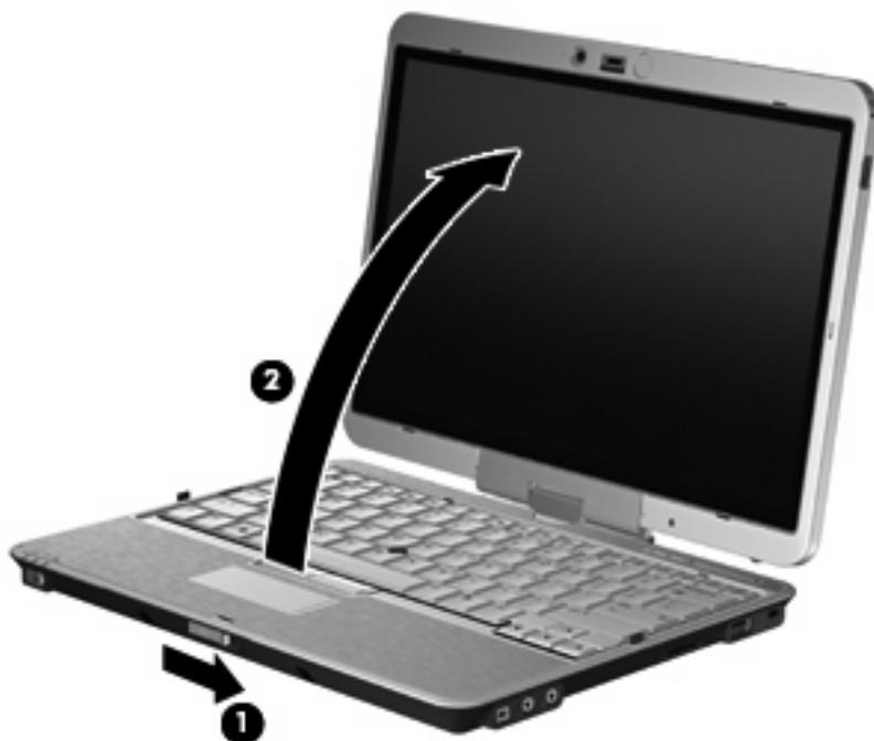
2. Gire la pantalla del equipo hacia la derecha hasta que se ajuste en su posición y quede en dirección opuesta al teclado.
