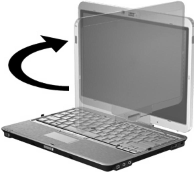
3. Incline la pantalla del equipo hacia abajo sobre el teclado hasta que encaje en la posición correcta.
