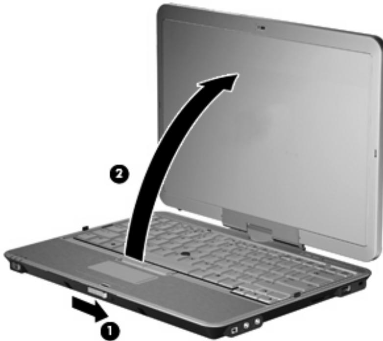
3. Drehen Sie das Display des Computers gegen den Uhrzeigersinn, bis es einrastet und zur Tastatur zeigt.
