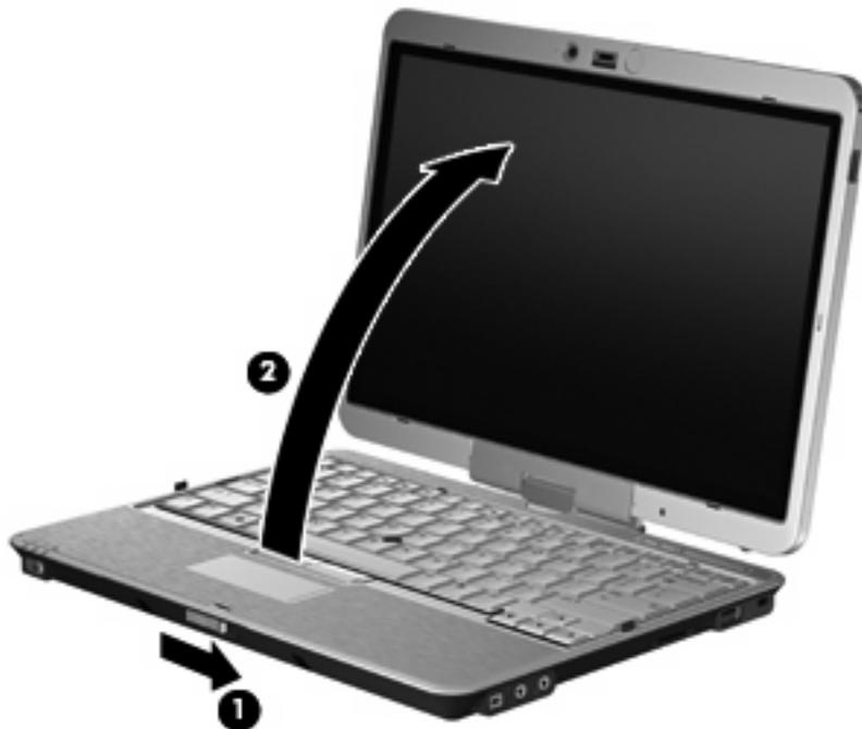
2. Drehen Sie das Computerdisplay im Uhrzeigersinn, bis es einrastet und in die der Tastatur entgegengesetzte Richtung zeigt.
