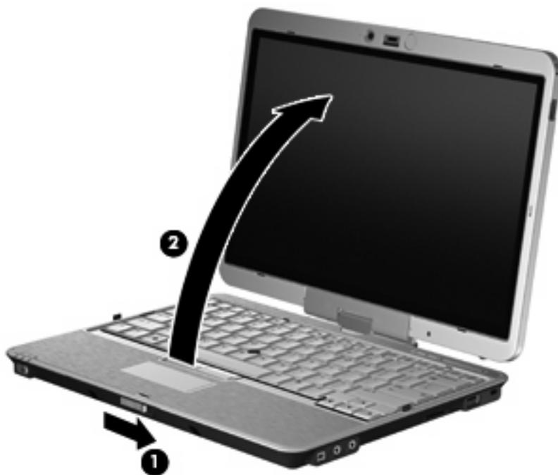
2. Faites pivoter l'écran de l'ordinateur dans le sens des aiguilles d'une montre jusqu'à ce qu'il soit en place et tourne le dos au clavier.
