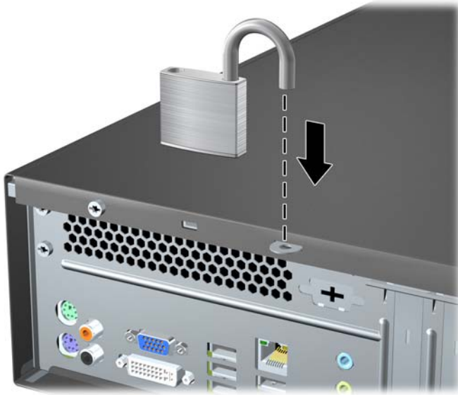
Figura C-2 Instalación de un candado
