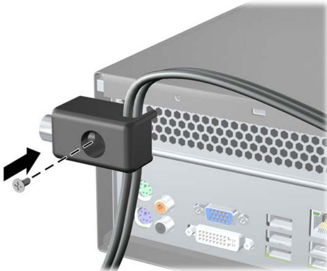
Figura C-5 Acoplado del Bloqueo al Chasis
