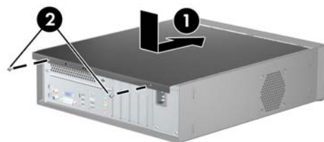
Figura 2-2 Reinstalación del Panel de Acceso de la Computadora
