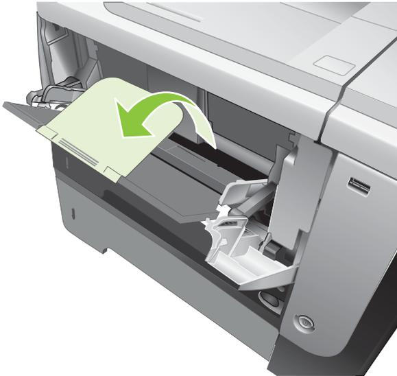
3. Legen Sie das Papier in das Fach ein. Stellen Sie sicher, dass sich das Papier vollständig unterhalb der Halterungen und unterhalb der Markierungen für die maximale Stapelhöhe befindet.
